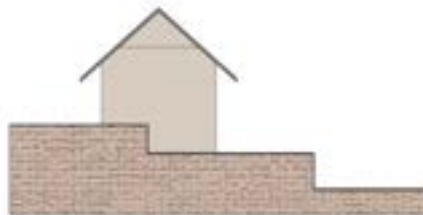
Terrain en terrasses : s'ancrer sur les murets de soutènement.
