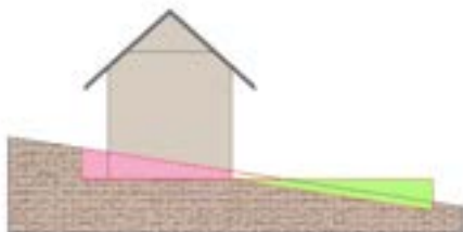
Terrain en pente : équilibrer les déblais-remblais
